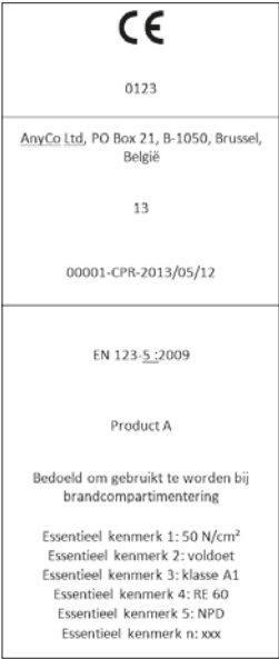
Fig.3 - Een voorbeeld van CE-markering, in overeenstemming met de Bouwproductenverordening. _Fig. 3 - Un exemple de marquage CE, conforme au règlement Produits de la construction.
